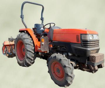
**RIBALTAMENTO** Installare cabina o arco di protezione anti-ribaltamento da officina specializzata secondo linee guida INAIL/ISPSEL
